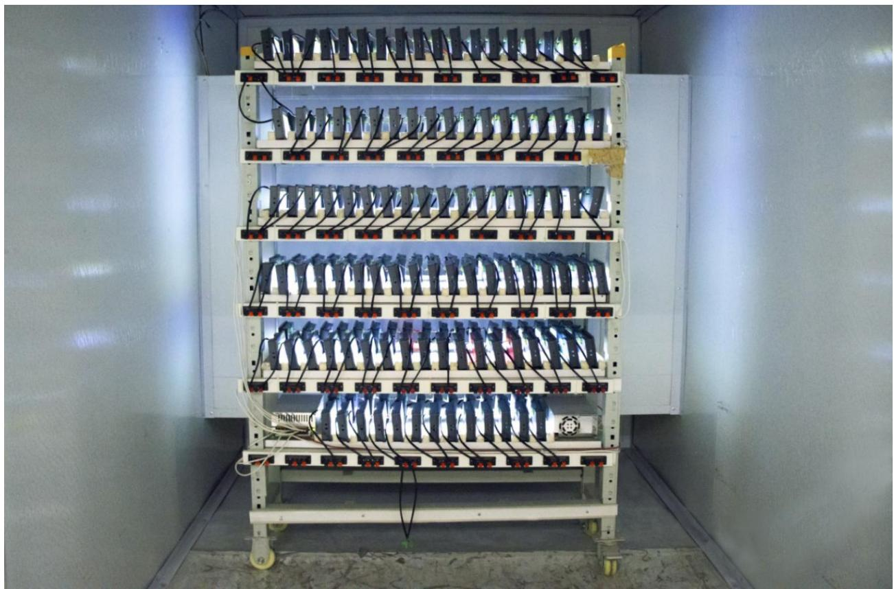
测试环境:高低温老化测试箱中
